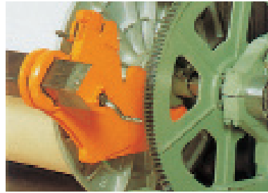
Höhenverstellbare Rohrgreifern z.B. im Fall von Universallagerung Tube grippers adjustable in height, e.g. in case of universal bearing
