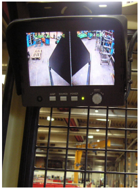
Kamerasystem mit geteiltem Monitor zur exakten Kontrolle der Lastaufnahme
