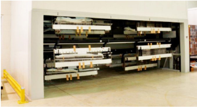
Ausführung als Schaft-Lager Execution for storing harness frames
